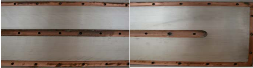
Şekil 8. Cu/Sn target’ in yapıştırma ve yüzey temizleme işlemleri sonrası iki ayrı bölgeden fotoğrafları.
