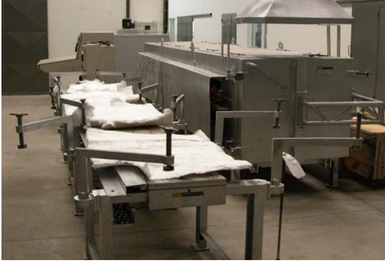
Şekil 7. Büyük target imalatında kullanılan ve yük uygulamak için sabit mangelere sahip endüstriyel boyutlu sıcak tabla görüntüsü. Fotoğrafta tablanın yanında ‘refill’ için gelen Cu/Sn target üzerinden kalayın sökülmesinde kullanılan fırın görülmektedir.
