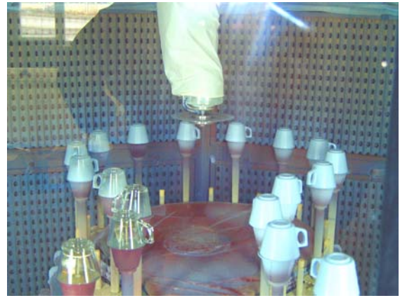
Resim-2 Omega konveyör yapısı ve aşağı-yukarı hareket mekanizması
