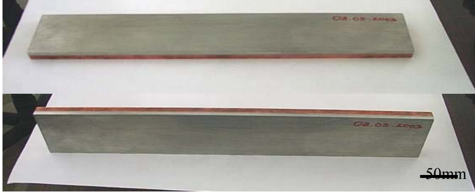
Şekil 6. Şişecam A.Ş.' de Ar-Ge amaçlı kullanılan 'küçük target'e yakın boyutlarda olan ve Sn-In ara bağlayıcı ajan kullanılarak yapıştırılmış Cu/Sn metal çifti görüntüsü.
