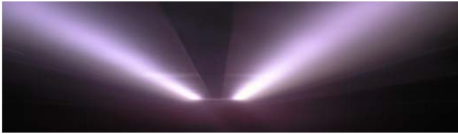
Şekil 9. TÜBİTAK-MAM, MKTAE’ de üretilen Cu/Sn target’ in ŞİŞECAM Trakya Cam Sanayii A.Ş. Cam İşleme ve Kaplamalı Camlar Fabrikasında bulunan Kaplama Hattında kullanıldığı andaki görüntüsü.
